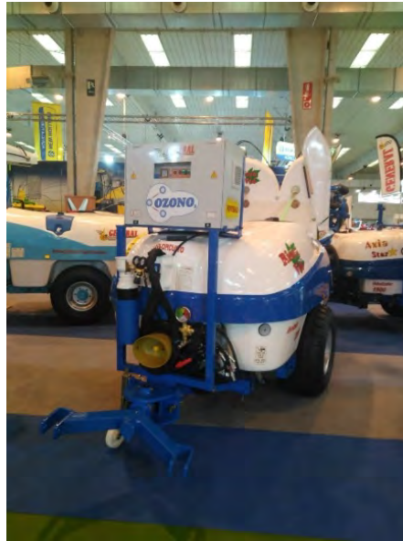
Figure 6. Générateur d'ozone et pulvérisateur d'eau ozonée utilisable au vignoble, en exposition à la foire de Saragosse.
